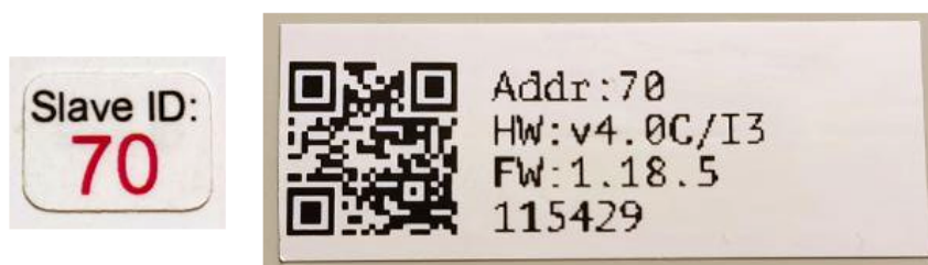
Рис. 14. Modbus-адрес, установленный на производстве. Слева – наклейка на крышке устройства. Справа – наклейка на боковой стенке или нижней стороне устройства.
