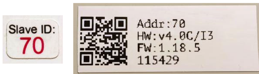
Рис. 26. Modbus-адрес, установленный на производстве. Слева – наклейка на крышке устройства. Справа – наклейка на боковой стенке или нижней стороне устройства.
