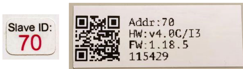
Рис. 8. Modbus-адрес, установленный на производстве. Слева – наклейка на крышке устройства. Справа – наклейка на боковой стенке или нижней стороне устройства.
