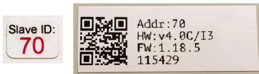
Рис. 12. Modbus-адрес, установленный на производстве. Слева – наклейка на крышке устройства. Справа – наклейка на боковой стенке или нижней стороне устройства.
