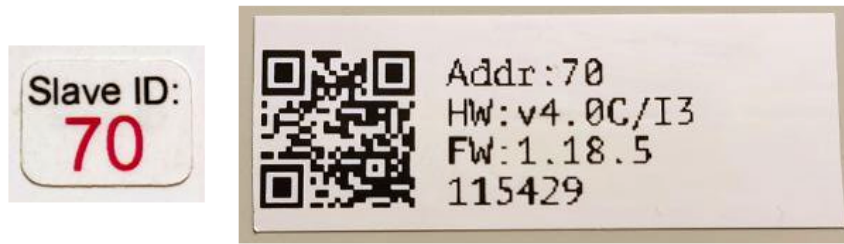
Рис. 23. Modbus-адрес, установленный на производстве. Слева – наклейка на крышке устройства. Справа – наклейка на боковой стенке или нижней стороне устройства.
