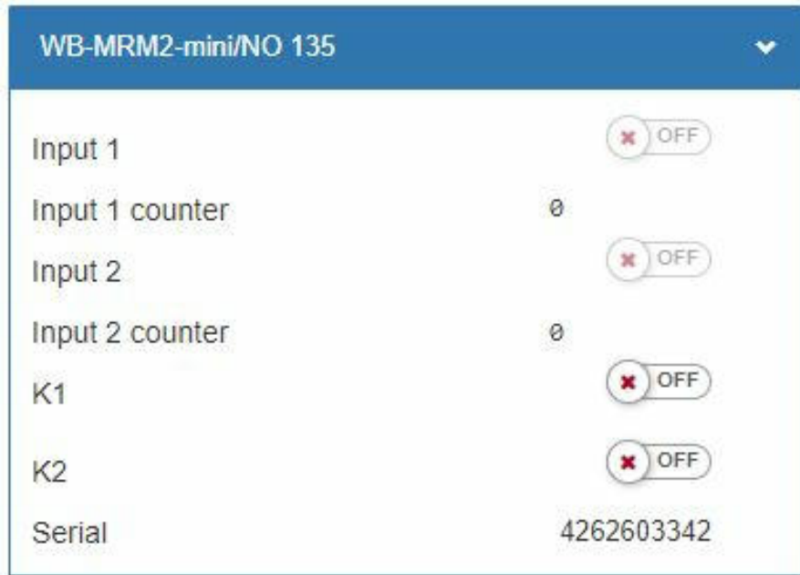
Рис. 21. Виджет модуля в веб-интерфейсе контроллера Wiren Board. Элементы управления и индикации модуля
